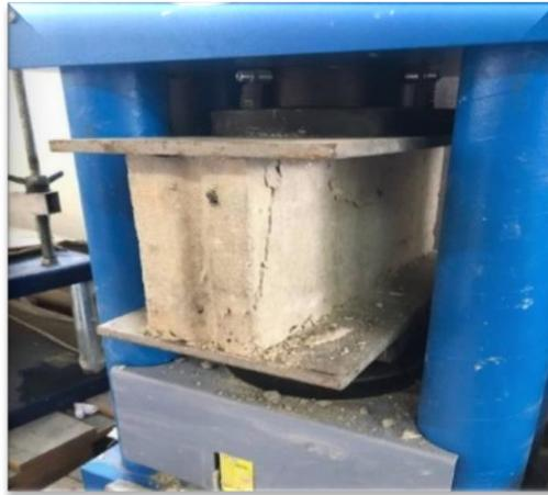
الشكل (6) اختبار البلوك على مقاومة الضغط
