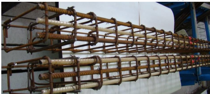
الشكل (4): شكل هياكل التسليح للجوائز البيتونية المسلحة بشكل هجين (بثلاثة قضبان 2 زجاجية GFRP و 1 فولاذي) أو (بثلاثة قضبان 1 زجاجي GFRP و 2 فولاذية) وهي موضعية مقلوبة.
