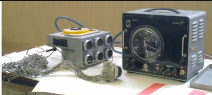
الشكل (8): جهاز قياس التشوهات النسبية في كل من قضبان الزجاجية GFRP والفولاذية والبيتون المضغوط.
