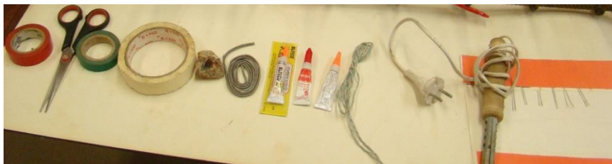
الشكل (9): الأدوات والمواد المستخدمة لتوصيل ولصق وعزل الحساسات بعد لصقها على القضبان الزجاجية GFRP والفولاذية والبيتون المضغوط.
