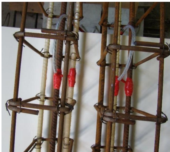
الشكل (6): هيكل التسليح للجوائز البيتونية المسلحة بشكل هجين، مبين على مكان لصق حساسات تشوه على القضبان الزجاجية GFRP والفولاذية وكيفية عزل الحساسات حتى لا تتضرر أثناء عملية الصب.
