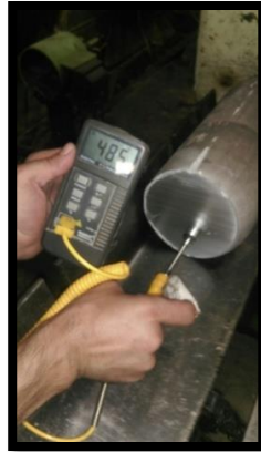
الشكل 16. قياس درجة حرارة بيليت الألمنيوم بعد التسخين المسبق قبل البثق
