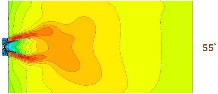
الشكل (10): توزيع درجات الحرارة الكلية داخل حجرة الاحتراق عند زوايا مختلفة لشفرات الهواء الرئيسي
