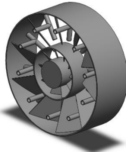
الشكل (3): رسم ثلاثي الأبعاد للحراق الدوامي بعد التبسيط
