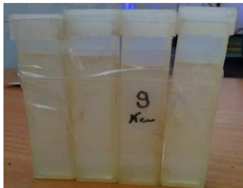
الشكل 5-1: قالب تحضير العينات للمعالجة الإشعاعية
