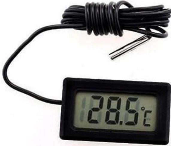
الشكل(7): مقياس الحرارة الدجيتال مع المزدوجات الحرارية.
