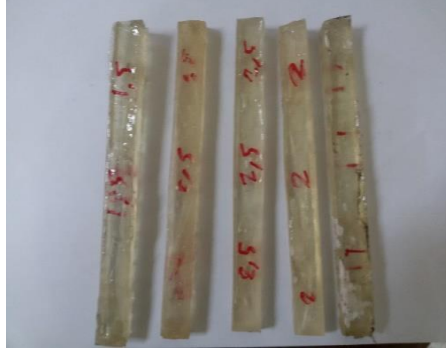
الشكل 5-1: بعض عينات الانحناء التي تم تحضيرها للاختبارات
