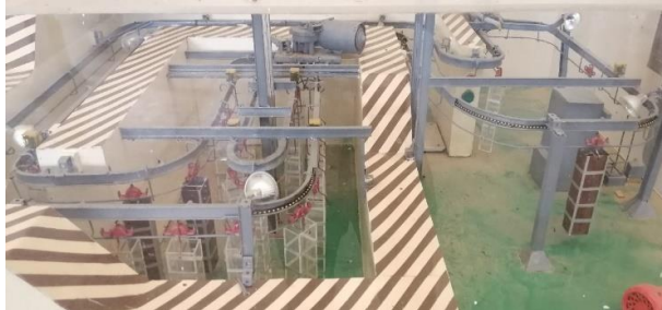
الشكل 5-3: شكل مجسم لغرفة التشعيع
