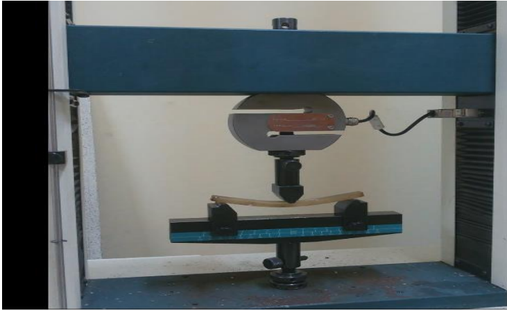
الشكل 6-1: اختبار مقاومة الانحناء للعينات
