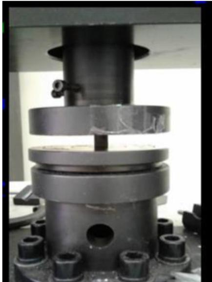
الشكل (15) وضع العينة بوضع متمركز مع قرص الجهاز في اختبار المقاومة على الانضغاط.
