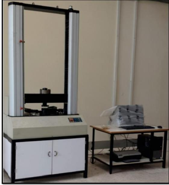
الشكل (6) جهاز الاختبارات الميكانيكية العامة طراز (WDW-50).
