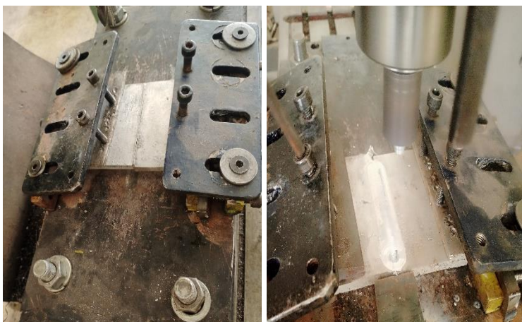
الشكل (7): تنفيذ اللحام على العينات المعالجة حرارياً
