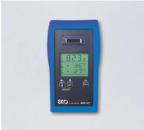
الشكل (16) جهاز قياس شدة الاشعاع الشمسي
