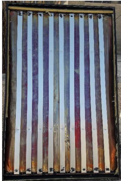
الشكل (9) تثبيت قنوات التبريد خلف السطح الماص
