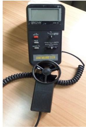
الشكل (15) مقياس سرعة الهواء
