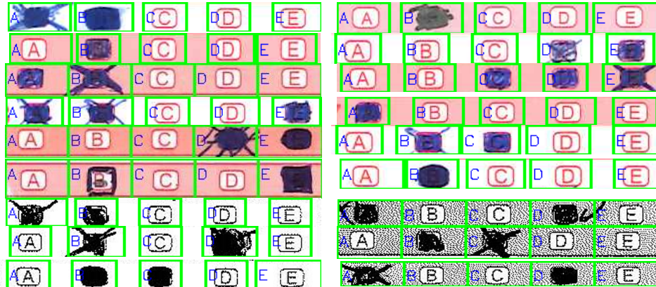
الشكل 7 - صور توضيحية لنتائج تطبيق خوارزمية اكتشاف الفقاعات DBSCAN
