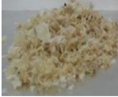
الشكل (1) - مجروش نفايات رقائق البيوت البلاستيكية (RLDPE)
