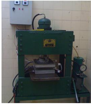
الشكل (3) - مكبس تشكيل نصف هيدروليكي
