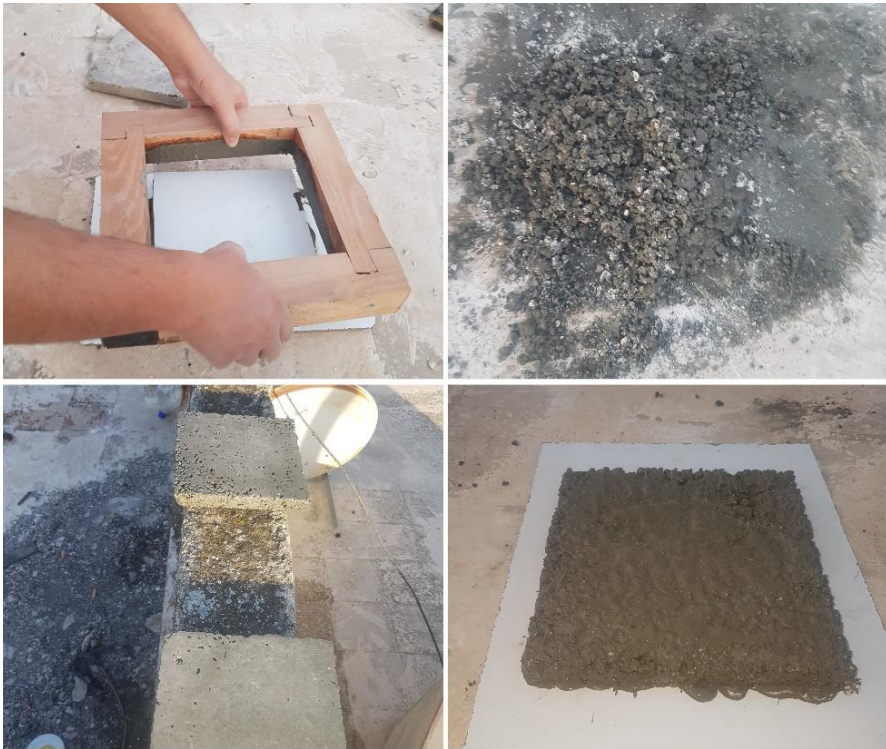
الشكل (10) يبين مراحل صب العينات الإسمنتية
