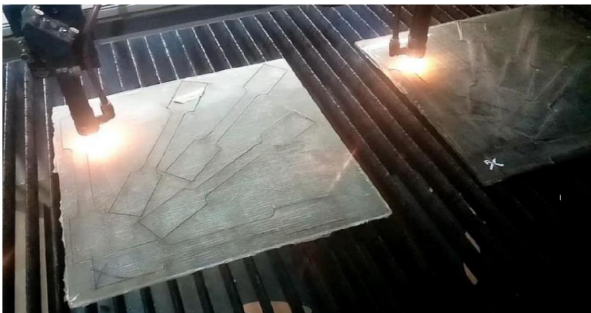
الشكل (5): قص العينات باستخدام آلة القص بالليزر
