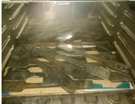
الشكل (6): فرن المعالجة الحرارية لعينات الشد
