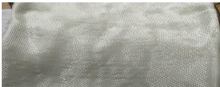
الشكل (1): نسيج ألياف الكتان المستخدم كألياف تقوية
