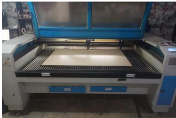
الشكل (2): آلة القص بالليزر المستخدمة
