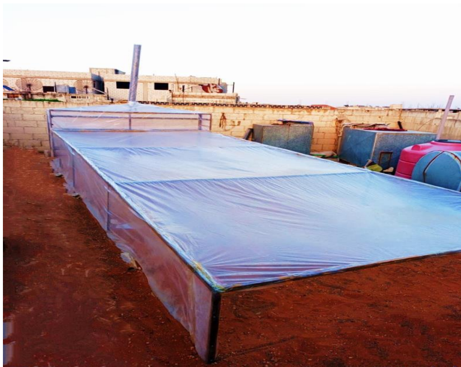
الشكل (2): المجفف الشمسي المصمم حالة ارضية المجمع رمل
