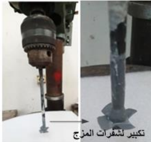
الشكل 6. عملية المزج الميكانيكي بواسطة
