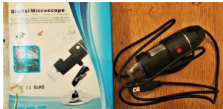
الشكل 3. الميكروسكوب الرقمي ( Digital Microscope) بتكبير 500 \times .
