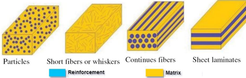
الشكل (3) طرائق التدعيم التقليدية للألمنيوم
