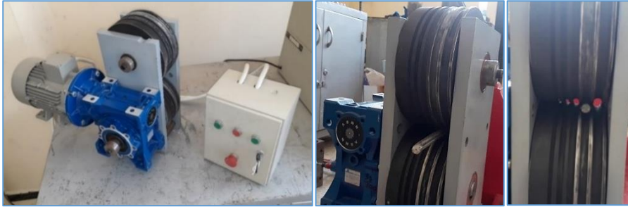
الشكل (10) ماكينة الدرفلة المصنعة محلياً ومبدأ درفلة العينات الدائرية
