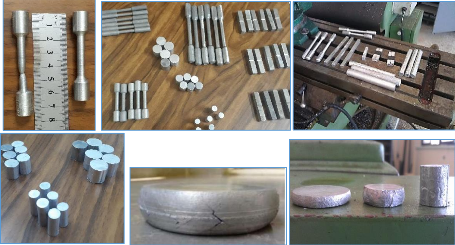
الشكل (16) عينات الاختبارات الميكانيكية والفحص المجهرى
