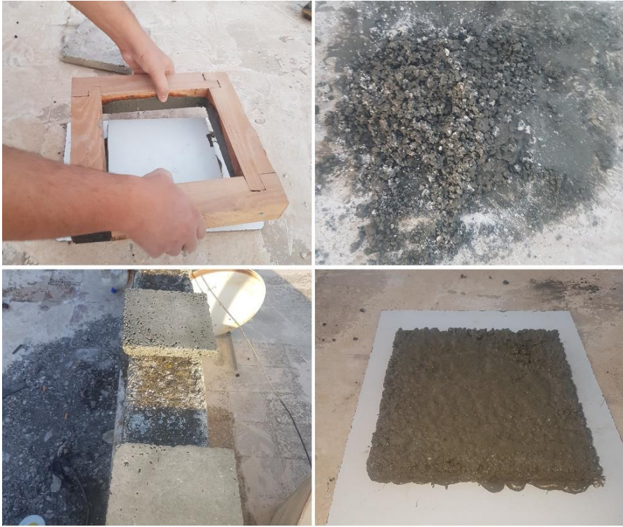
الشكل (10) يبين مراحل صب العينات الإسمنتية
