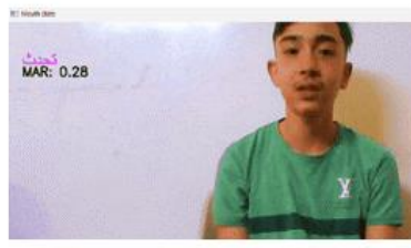
الشكل 9 يوضح حالة التحدث حيث تم رصد دورات فتح وإغلاق بشكل مكرر
