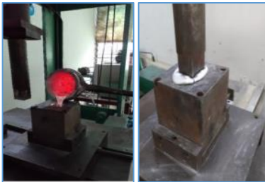
الشكل (10) مكبس الضغط -قالب الصب المعدني-حامل البوتقة- تطبيق ضغط العصر (50 MPa)
