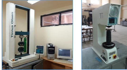
الشكل (12) أجهزة الفحص والاختبارات : (جهاز الشد -جهاز القساوة) في مخبر علم المواد والمعالجات الحرارية بكلية الهندسة الميكانيكية والكهربائية بجامعة حمص.
