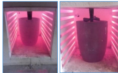
الشكل (9) فرن الصهر - ميكانيزم الخلط- بوتقة الصهر-منظم الحرارة-وحدة ضبط السرعة-عبوات دقائق الكريد
