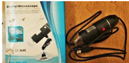
الشكل 3. الميكروسكوب الرقمي ( Digital Microscope) بتكبير 500 \times .
