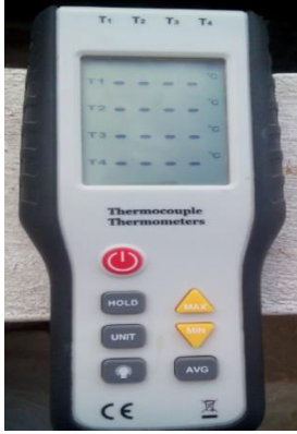
الشكل (14) جهاز الثيرمو متر الرباعي لقراءة درجات الحرارة من الحساسات
