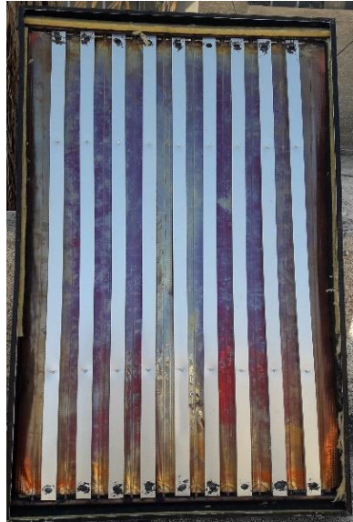
الشكل (9) تثبيت قنوات التبريد خلف السطح الماص
