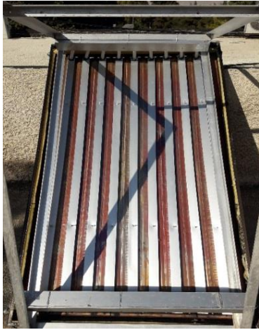
الشكل (11) الدكاتات الموصولة مع جسم الهيكل المعدني و قنوات التبريد
