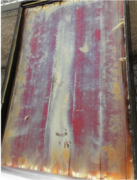
الشكل (9) تثبيت قنوات التبريد خلف السطح الماص
