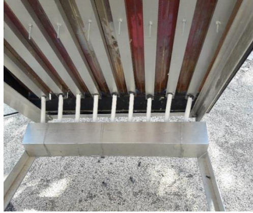
الشكل (11) الدكاتات الموصولة مع جسم الهيكل المعدني و قنوات التبريد
