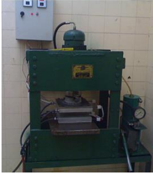
الشكل (3) - مكبس تشكيل نصف هيدروليكي
