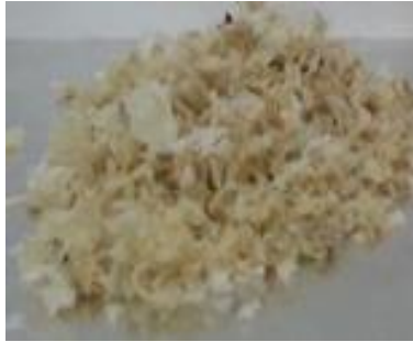
الشكل (1) - مجروش نفايات رقائق البيوت البلاستيكية (RLDPE)
