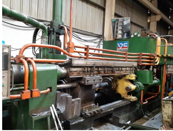
الشكل 20. مكبس بثق ألمنيوم 6inch - شركة الزين
