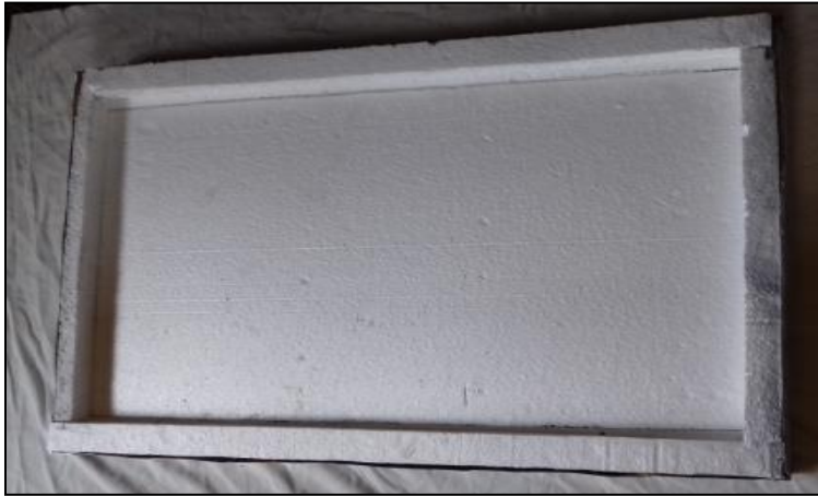
الشكل (5) عزل المجمع باستخدام الفلين الصناعي
