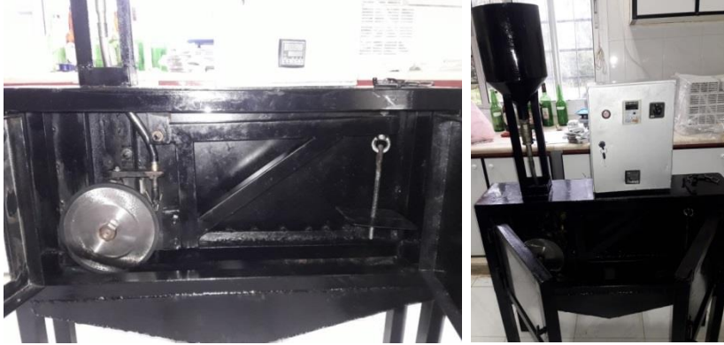
الشكل (10): جهاز اختبار الاهتراء بالرمل الجاف والعجلة المطاطية المستخدم مع وحدة التحكم والفرملة
