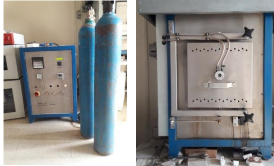
الشكل (5): فرن التليد الكتيم من نوع HT 1600 M مع وحدة التغذية الكهربائية والتحكم الخاصة به
