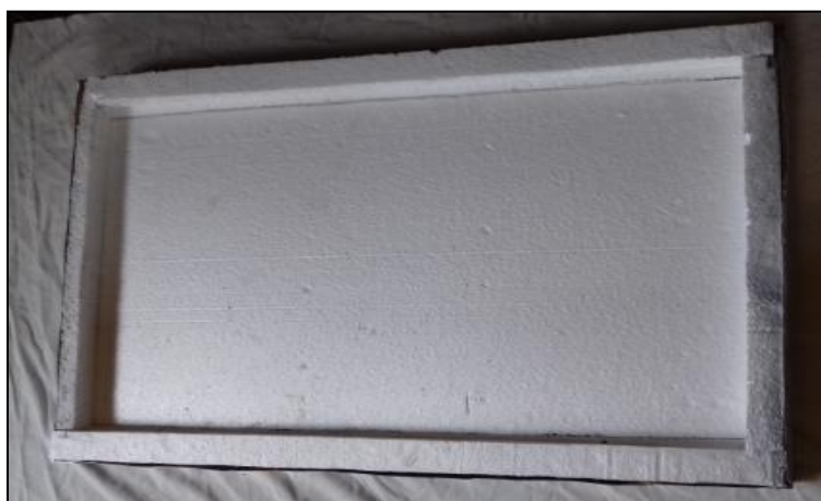
الشكل (5) عزل المجمع باستخدام الفلين الصناعي
