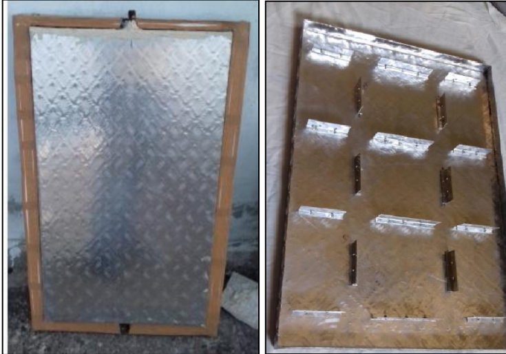
الشكل (7) توزع الشفرات (زعانف وحواجز) على السطح الداخلي للماص
