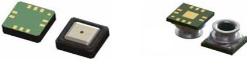
الشكل (6): حساسات قياس ضغط الدم أبعادها 2 \times 2 \text{ mm}
