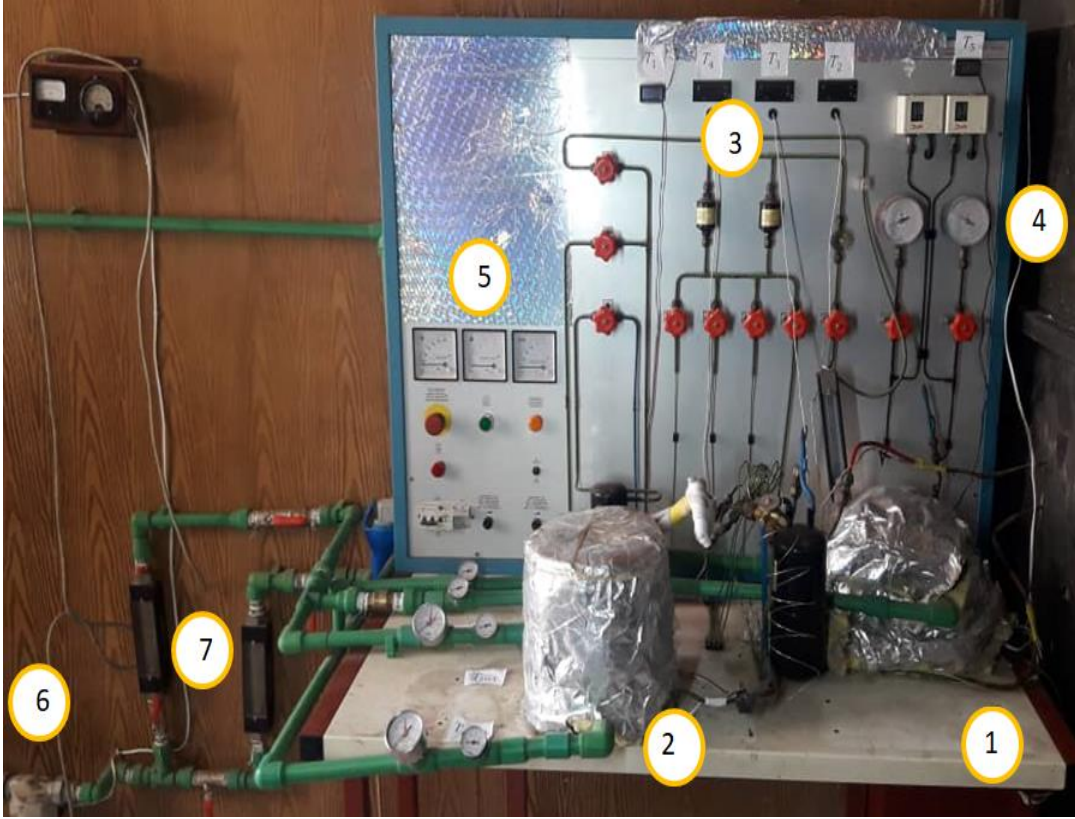
الشكل (2) أجزاء المنصة التجريبية المجهزة ، 1: الضاغط مع وحدة امتصاص الحرارة، 2: المبخر المائي ، 3: حساسات قياس الحرارة، 4: مقياسا ضغط السحب والطرء، 5: مقاييس استطاعة كهربائية، 6: مضخة تدوير المياه، 7: مقاييس تدفق المياه مع التوصيلات.
