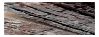
الشكل(7) فصل بين طبقات الصفائح المركبة بأساس ألياف بازلتية 880g/m² بشكل كامل الشكل (7) العينة 4
