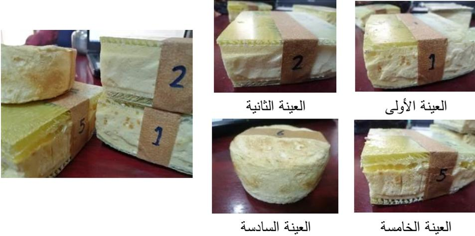
الشكل (8): صور العينات المُعرَّضة لاختبار تحمل العوامل الجوية (التقادم المُسرَّع)
