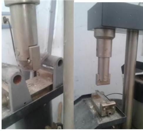
الشكل (5): اختبار مقاومة الانحناء
