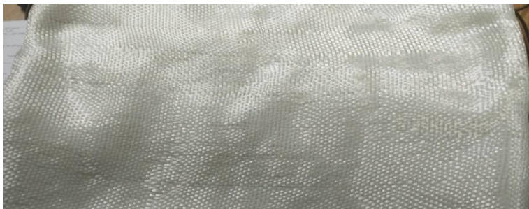
الشكل (1): نسيج ألياف الكتان المستخدم كألياف تقوية
