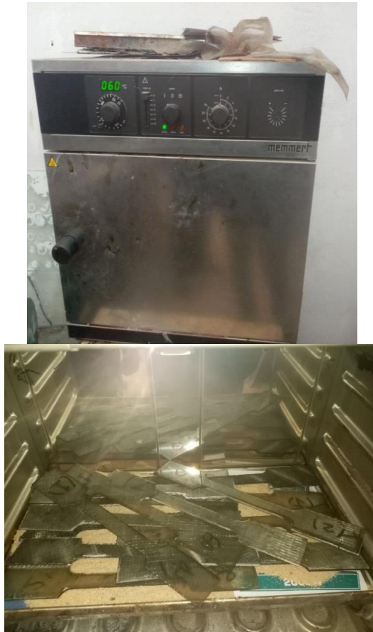
الشكل (6): فرن المعالجة الحرارية لعينات الشد
