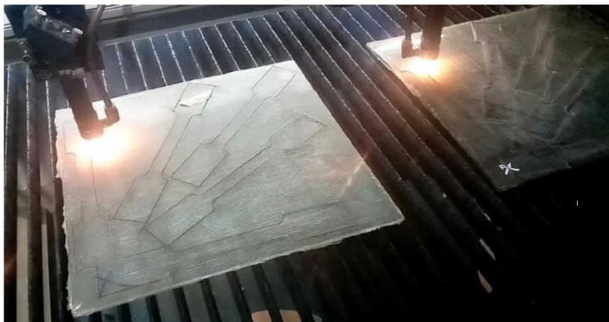
الشكل (5): قص العينات باستخدام آلة القص بالليزر
