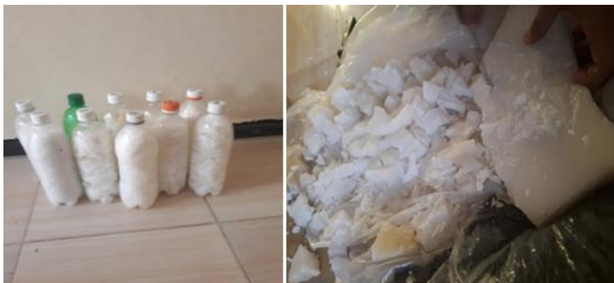
الشكل 2: المادة متغيرة الطور (الشمع البارافيني ) ضمن العبوات
