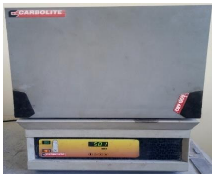
الشكل(2):الفرن الكهربائي المستخدم في المعالجة الحرارية
