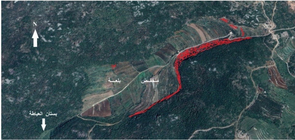
الشكل رقم 6: صورة جوية توضح منطقة وجود منخفض بلعة داخل صخور الجوراسي الوعرة، كما تشير الخطوط الحمراء إلى أماكن وجود سوية البازلت (Google Earth Pro).
