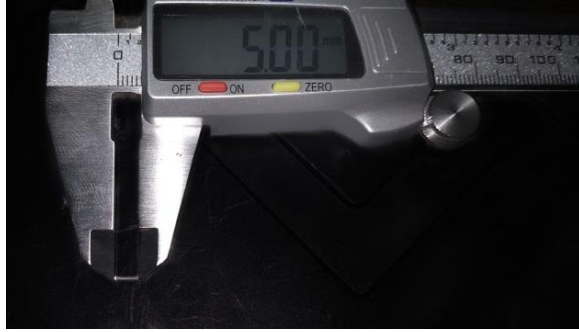
الشكل رقم(2): يمثل قياس طول السلك بواسطة مسماك الكتروني
