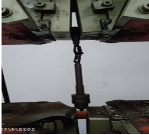
الشكل رقم (6) تثبيت الأسنان ضمن القوالب الإكريلية على قاعدة جهاز الاختبارات
