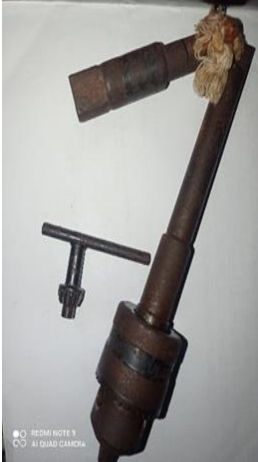
الشكل رقم (7) الرأس المستخدم لتثبيت الوتد ونقل قوة
