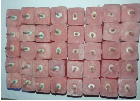
الشكل (4) عينة الأسنان بعد صبها بقوالب أكريلية
