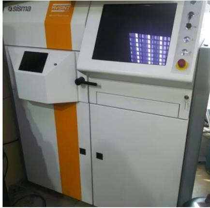
الشكل 6 : جهاز الصهر بالليزر (mysint100)
