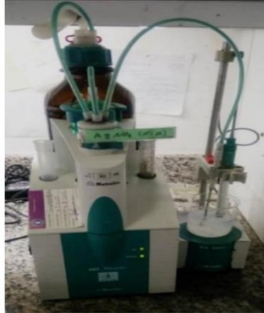
الشكل 4 جهاز المعايرة الكموونية **Titrand 888**
