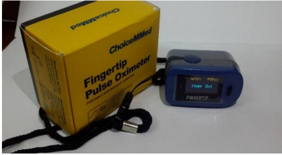
الشكل (2): جهاز قياس الإشباع الأكسجيني ومعدل النبض الإصبعي
