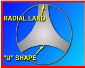
الشكل رقم (1): المقطع العرضي لنظام Radial-land على شكل Profile
