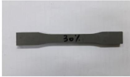
الشكل (9) عينة اختبار شد محضرة وفق مواصفة ASTM
