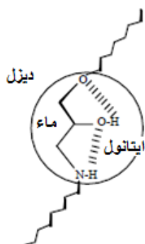
الشكل (1): تشكّل المذيلة micelle في المزيج ديزل-إيثانول-ماء.
