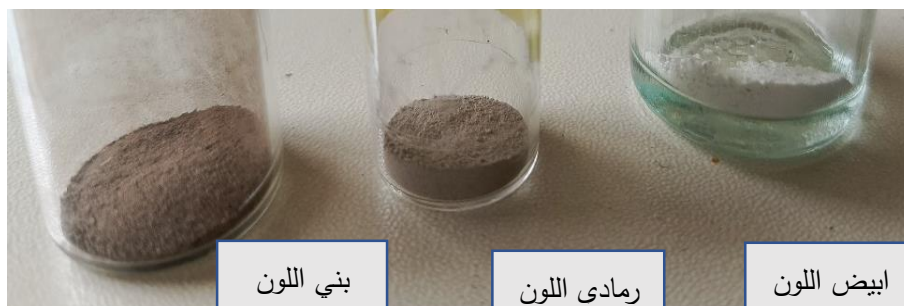
الشكل (10) : الفرق بين ألوان عينات أكسيد الزركونيوم المرمدة عند درجات حرارة مختلفة.
