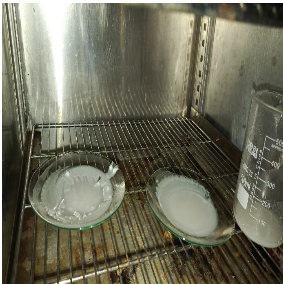
الشكل (7) : وضع الهيدروكسيد المحضر في المجفف حتى تمام التجفيف.
