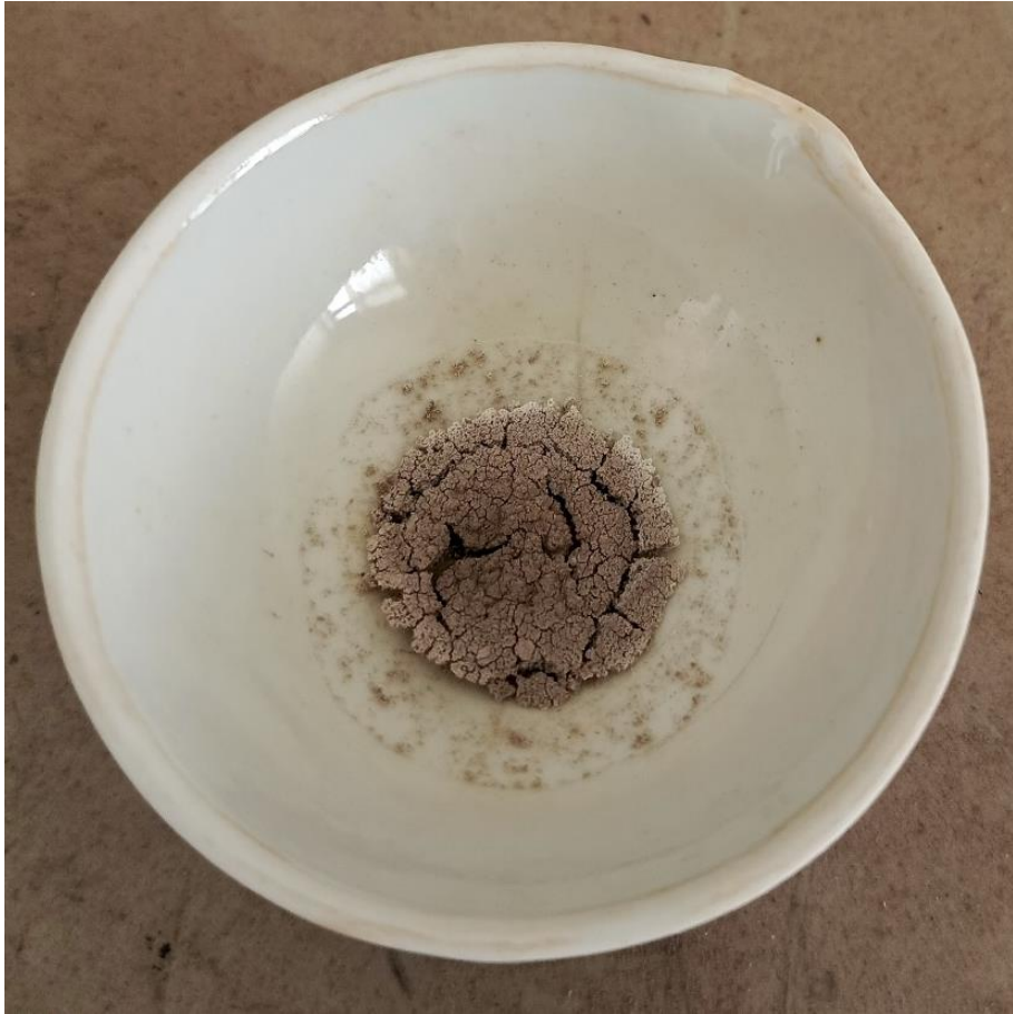
الشكل (9) : ترميد عينة من أكسيد الزركونيوم لمدة ساعتين عند درجة حرارة 300\text{ C}^0 .
