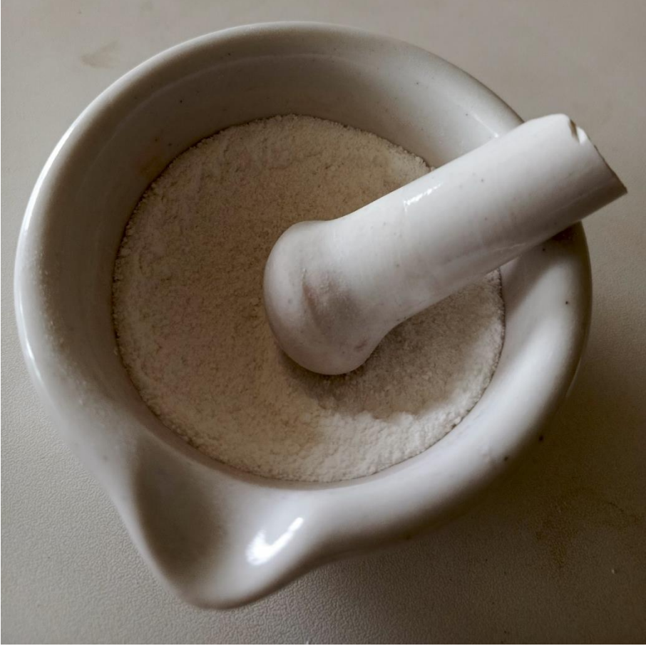
الشكل (8) : عملية طحن وتنعيم هيدروكسيد الزركونيوم.
