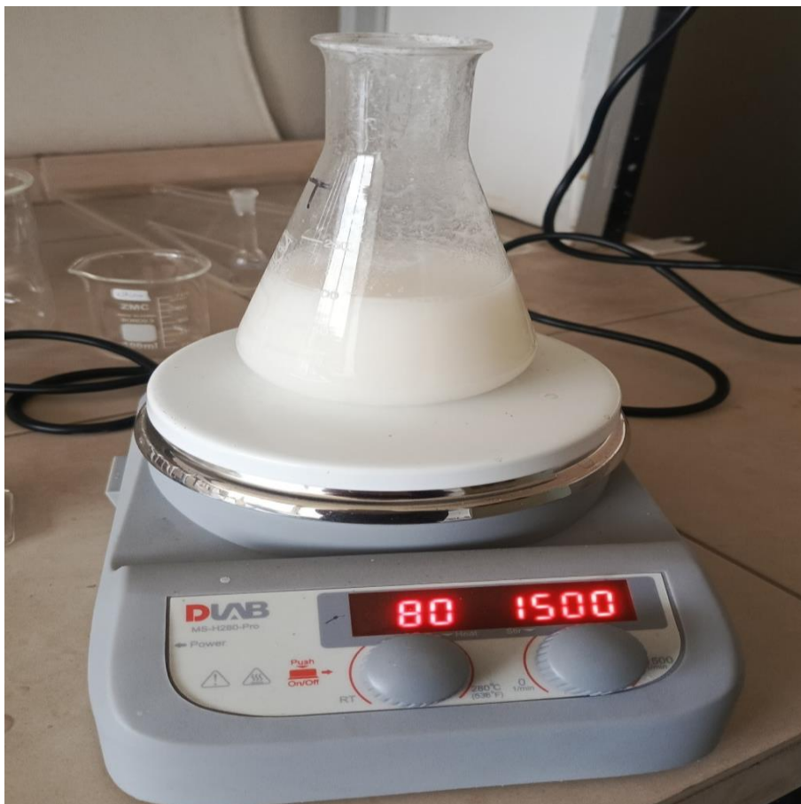
الشكل (5) : تسخين وتحريك المثبت مع الهيدروكسيد لمدة ساعة.
