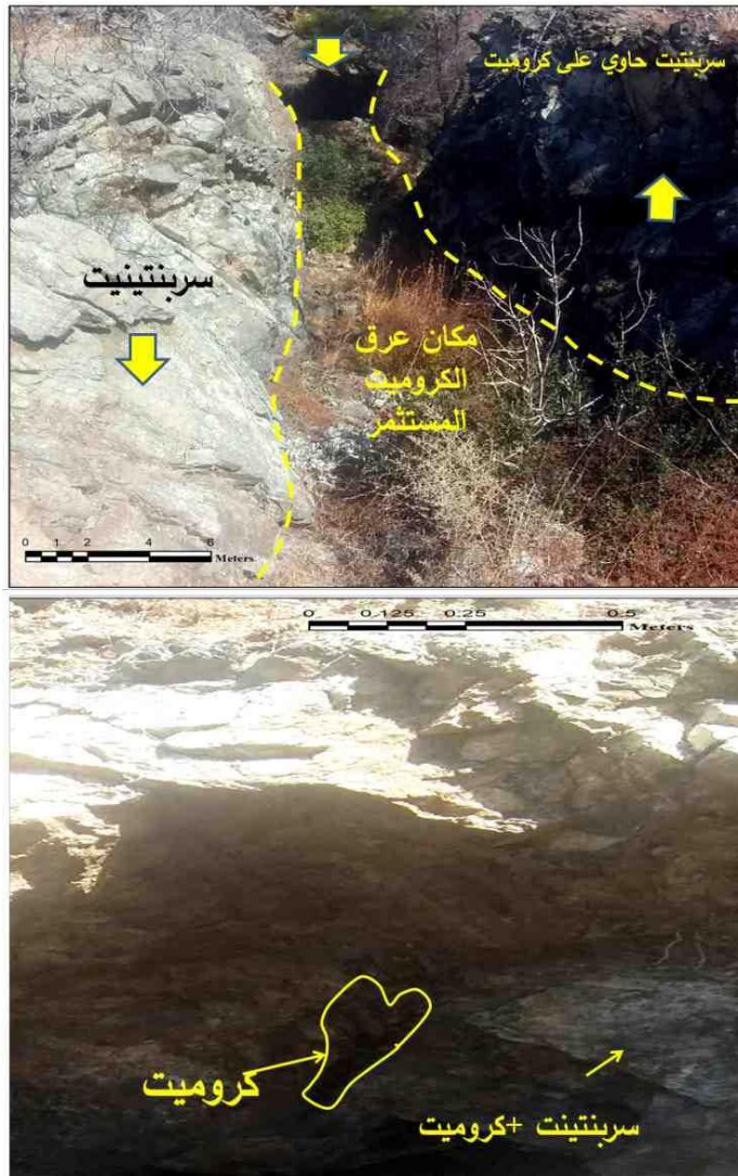
الشكل (11) جبهة تكشف الصخور السرينتينية الحاوية على عرق الكروميت المستمر في موقع العيسوية.
