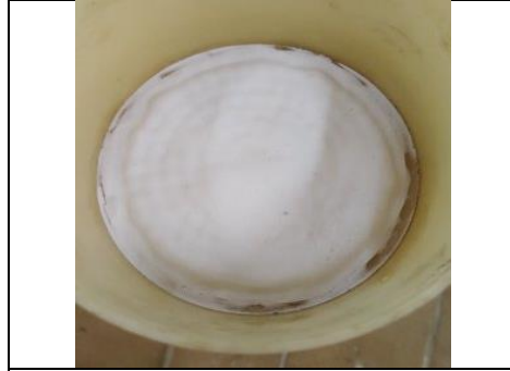
الشكل (1): عينة TLD-900 مشابهة بعد غسلها وتجفيفها بقمع بوخنر
