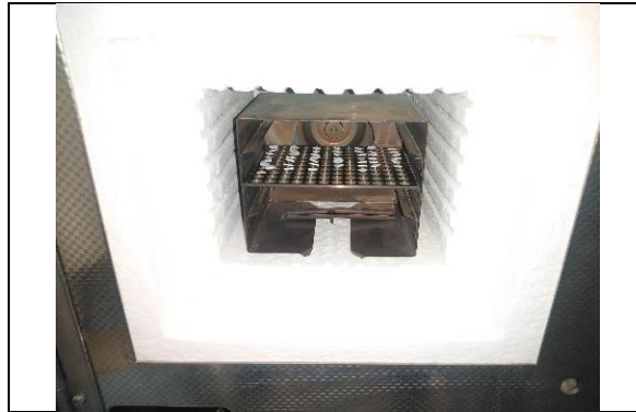
الشكل (7) الشرائح داخل فرن التصفير TLDO بعد التسخين
