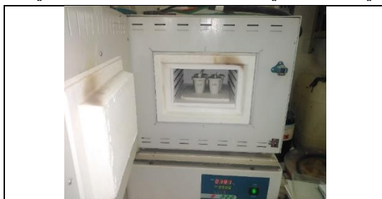
الشكل (3): الفرن الإلكتروني والعينات بداخله لبدء التسخين حتى 200^{\circ}C لمدة أربع ساعات
