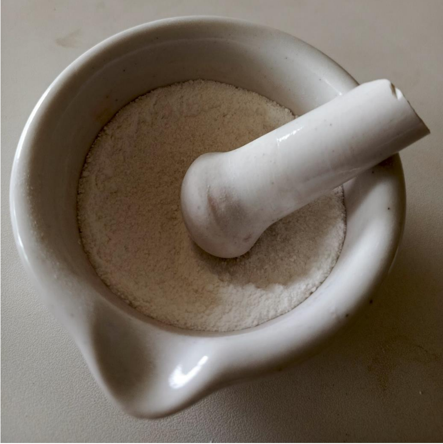
الشكل (8) : عملية طحن وتنعيم هيدروكسيد الزركونيوم.
