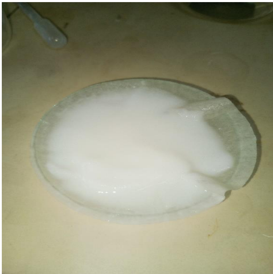
الشكل (2) : راسب هيدروكسيد الزركونيوم بعد الانتهاء من عملية الغسل.
