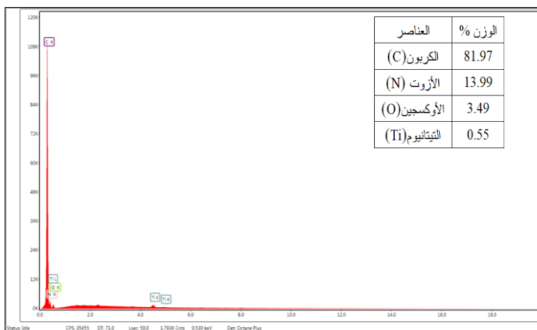
الشكل (13): طيف تقانة الأشعة السينية المشتتة للطاقة (EDXS) للعناصر المكونة للغشاء M2 ونسبتها المئوية
